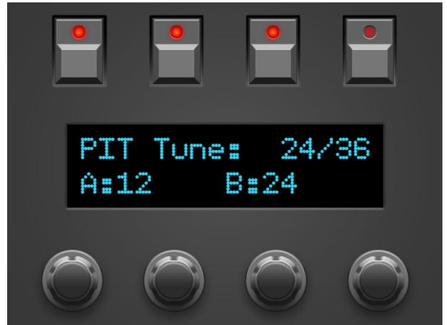
Der Reglerbereich verkleinert sich logischerweise, da mit dem Verschieben Schluß ist sobald der Channel mit dem größeren Wert seinen Maximalwert bzw. der Channel mit dem kleineren Wert den Minimalwert erreicht hat. Das Display zeigt im Relative Mode bei unterstützten Parametern anstelle eines Wertes, die Werte beider Channels an wie z.B. '24/36'.
